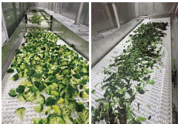
トンネル式フリーザーの内部。野菜(ブロッコリー(左)やホウレンソウ(右))を急速凍結する様子。
