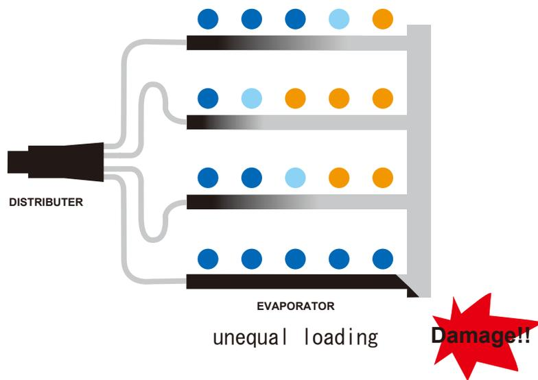
従来の冷凍システムでは、低凝縮温度 (tk)、小さい温度差 (TD) での運転ができません。
