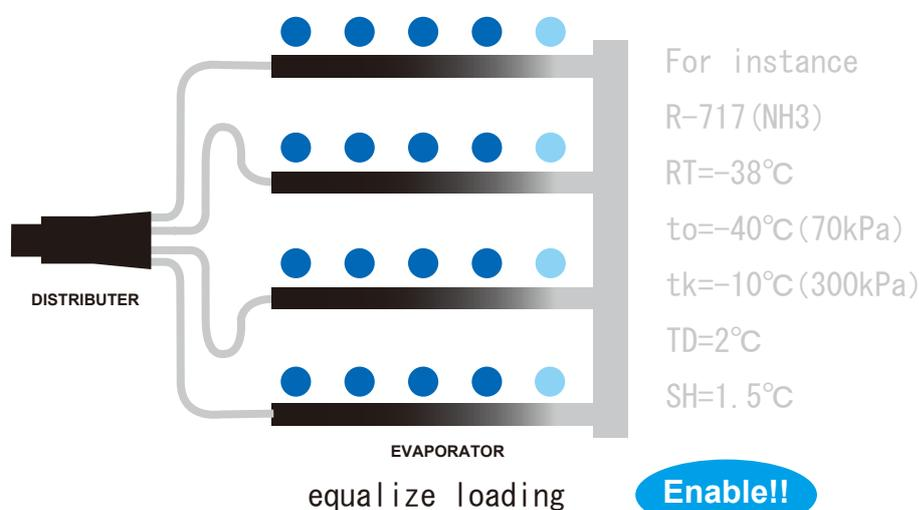
$\eta$  max Refrigeration System は違います。低凝縮温度 (tk)、小さい温度差 (TD) でも運転できます。
